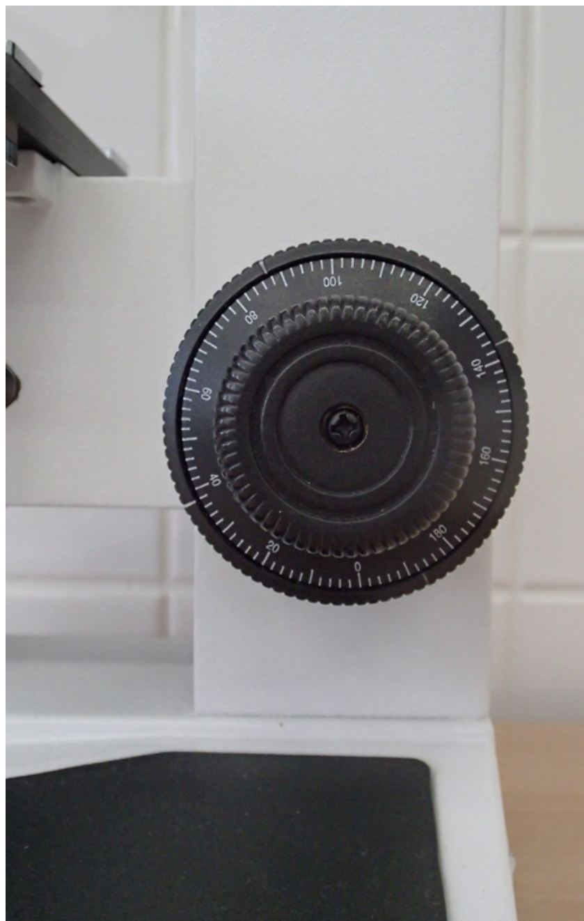
Fotografie č. 6: Detailní záběr na šrouby pro mikro- a makro-zaostřování
