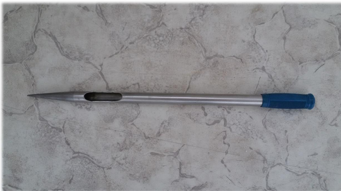
Obrázek č. 26: Vzorkovací kopí – vzorkovač na odběr zrnin z pytlů (autoři, 2019)
