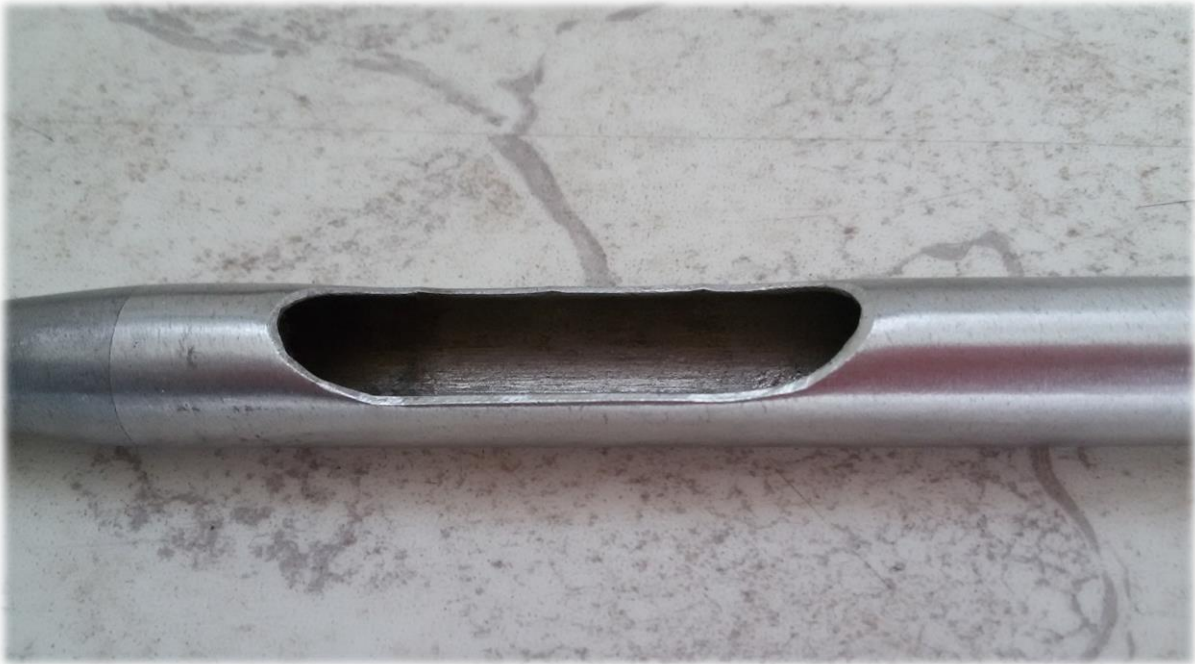
Obrázek č. 27: Vzorkovací kopí – vzorkovač na odběr zrnin z pytlů – detail otvoru (autoři, 2019)
