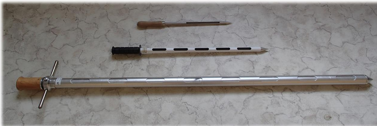
Obrázek č. 6: Horizontální jednoplášťové vzorkovače a vertikální dvouplášťový vzorkovač – různé velikosti (autoři, 2019)
