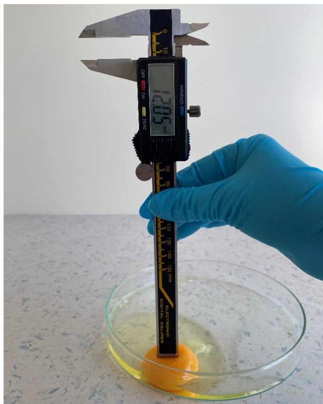
Obrázek 7 Měření výšky žloutku posuvným měřidlem
