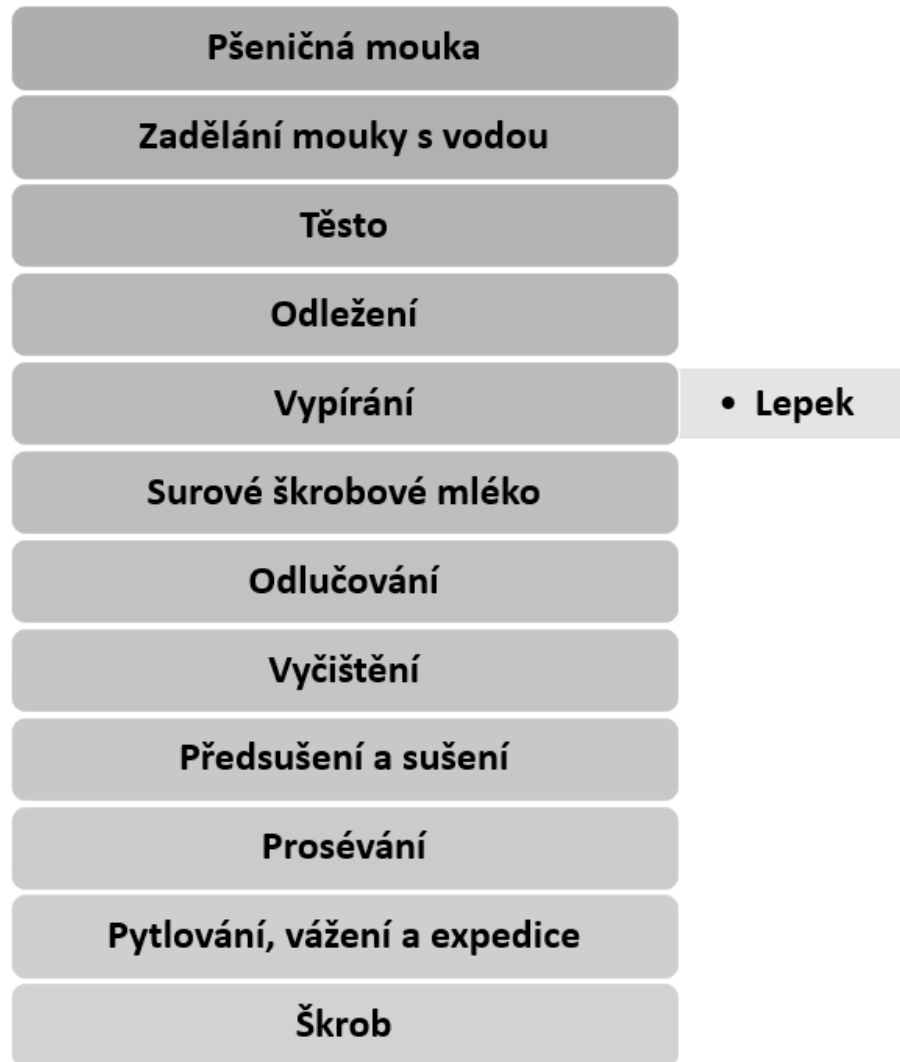
Obrázek č. 3: Schéma výroby pšeničného škrobu (Hromčíková, 2023)
