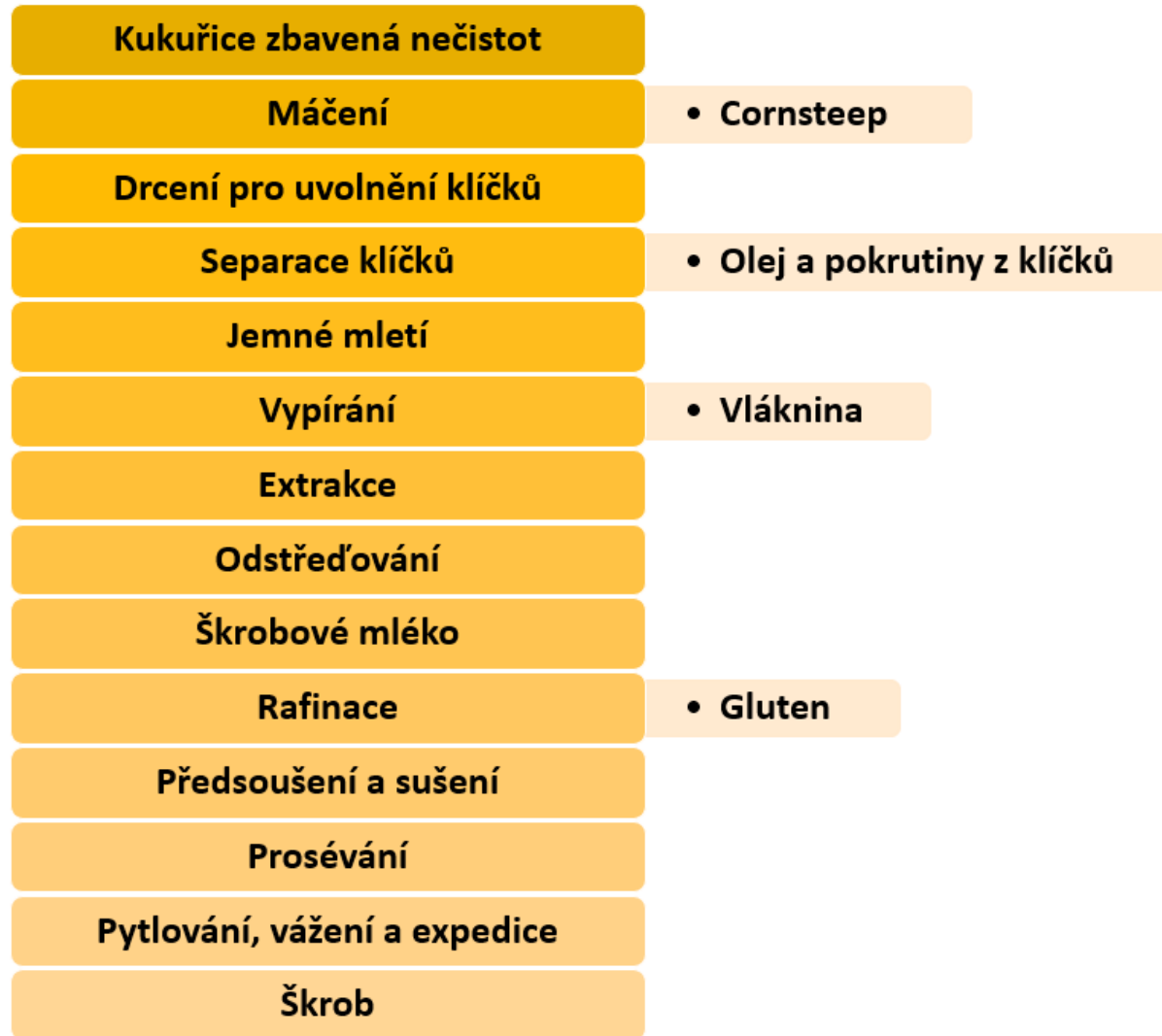
Obrázek č. 2: Schéma výroby kukuřičného škrobu (Hromčíková, 2023)
