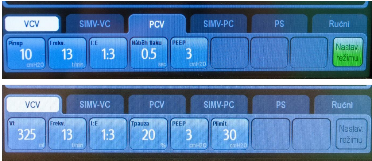
Obrázek 6 a 7: Příklad nastavení parametrů kontrolované tlakově řízené ventilace (nahore) a kontrolované objemově řízené ventilace (dole)
