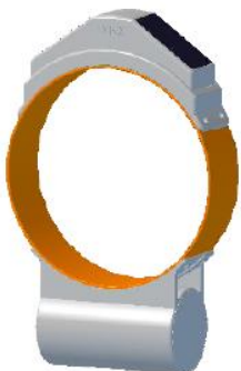
Obr. 26 Telemetrické zařízení ve formě obojku se solárním panelem a baterií. Určený pro šelmy o velikosti rysa ostrovida
