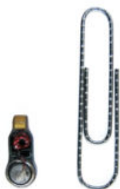
Obr. 22 Velikost akustického telemetrického zařízení v porovnání s kancelářskou sponou
