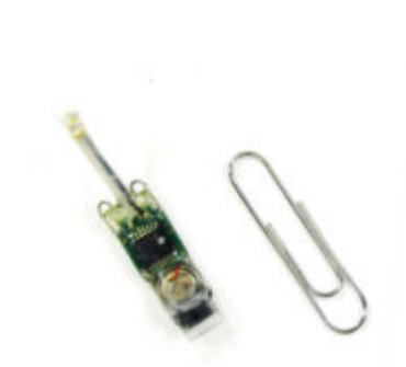
Obr. 48 Příklad velikosti geolokátoru ve srovnání s kancelářskou sponou
