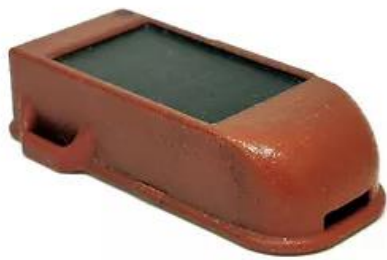
Obr. 24 Telemetrické zařízení typu batůžek se solárním panelem
